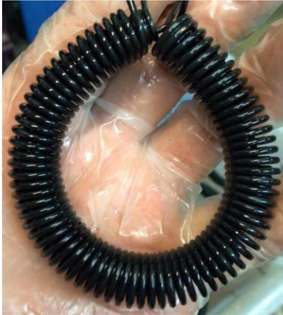
**Figure 10 :** Quand un morceau de cuivre est complètement noir, il y a entre 30 000 et 40 000 couches de nanoparticules.
