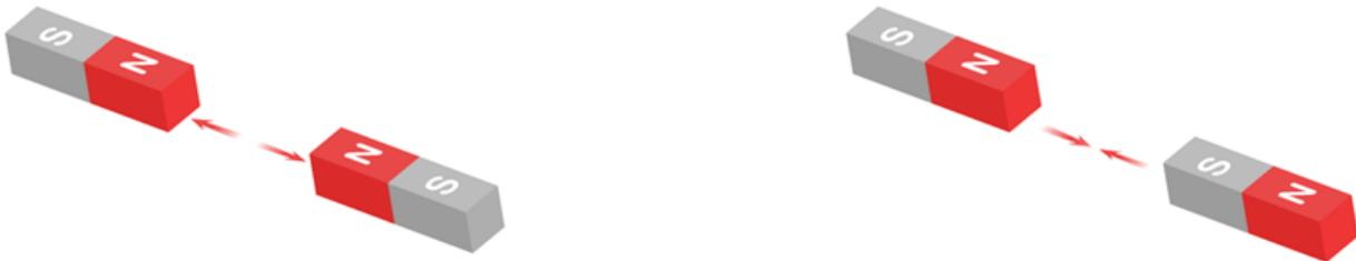
**Figure 3 :** L'image de gauche montre comment deux polarités semblables vont se repousser et celle de droite montre comment deux polarités opposées s'attirent et crée un équilibre.
